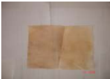
Hình 3.13. Vải nonwoven sau khi ngâm tẩm với dung dịch keo nano Ag
