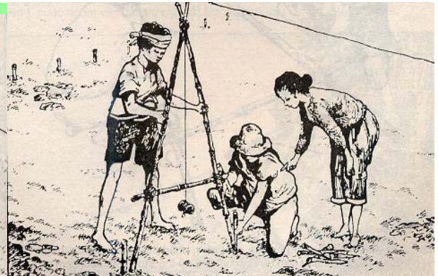
Những đường đồng mức này có thể được xác định bằng cách sử dụng một khung chữ “A”. Khung chữ “A” là dụng cụ đơn giản được làm bằng 3 thanh gỗ hoặc tre với một đoạn dây thừng và một hòn đá.
