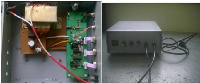
Hình 3.2: Nguồn phát xung cấp dòng cho laser bán dẫn
