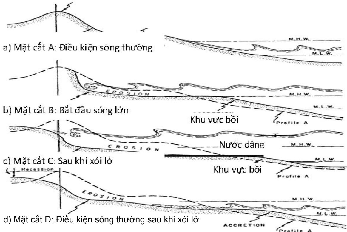
Hình 3.8. Sơ đồ quá trình gia tăng xói lở bờ khi nước biển dâng
